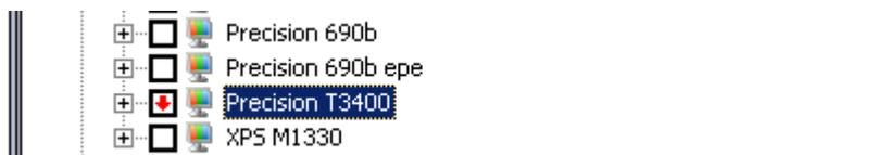
Dass das Hardwareprofil mit einem Klick in die *Checkbox* korrekt aktiviert wurde, ist an einem roten Pfeil zu erkennen. Es wurde somit der Eintrag für das entsprechende Hardwareprofil in der Datei ".\Empirum\EmpInst\Wizard\HWMisc" geschrieben. Das Hardwareprofil wird dadurch von entsprechenden Clients während der Betriebssysteminstallation erkannt, unabhängig davon, ob Treiber dafür vorhanden sind, oder nicht.
